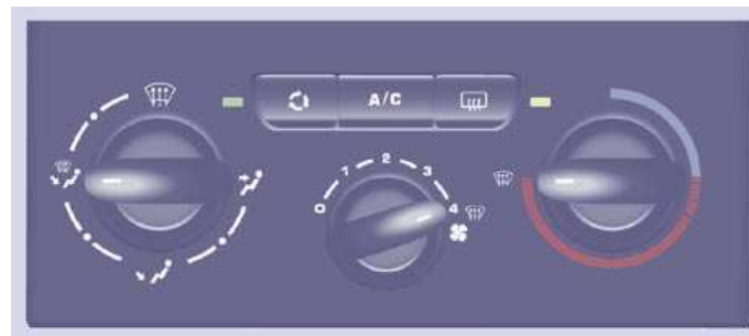
Façade air conditionné
